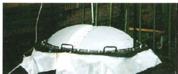
Bild 8. Überlappungsbereich im Bersttopfversuch Fig. 8. Simulation of overlap using burst strength equipment
