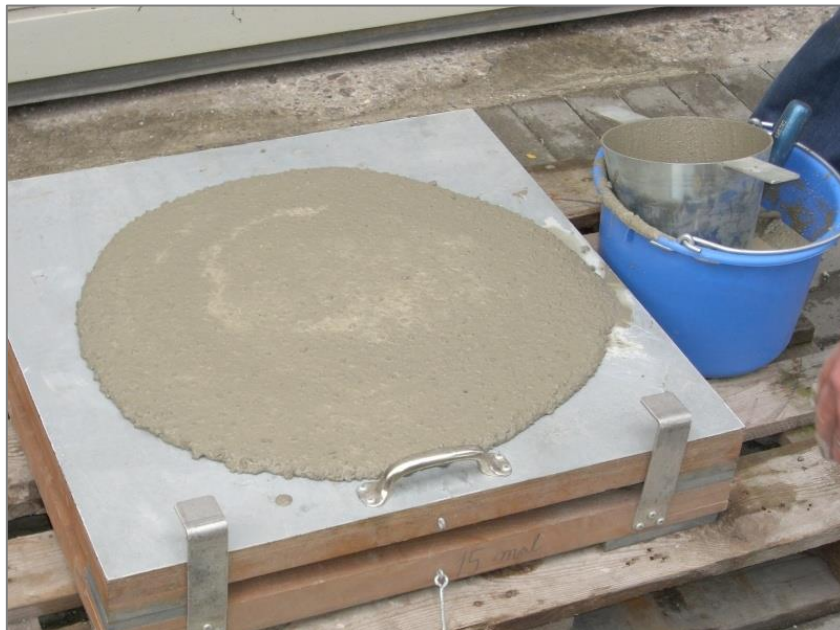
Figure 1: Essai d'étalement selon la norme EN 12350-5
