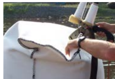
Fermeture des sacs à l'aide d'une machine à coudre manuelle
