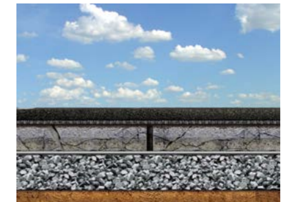
Réhabilitation de chaussées en béton
