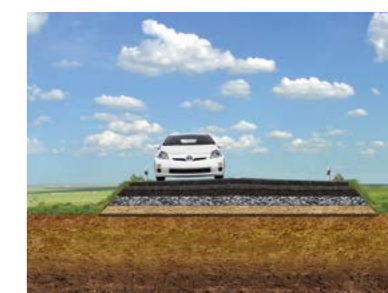
Construction de chaussées en enrobé
