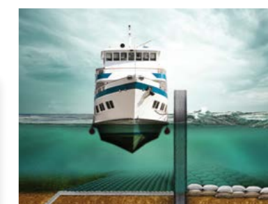
Protection du lit/protection anti-affouillement
