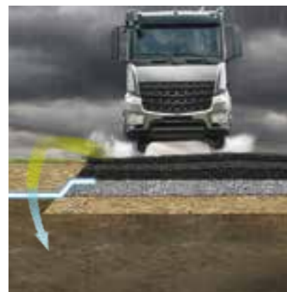
Traitement décentralisé des précipitations sur les routes
