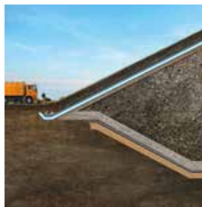
Scellement des ISD
