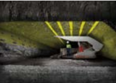
Front de taille - Soutien de longue taille chassante et des piliers
