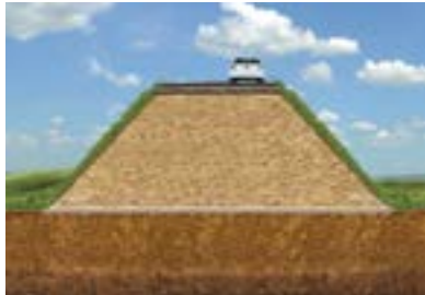
Remblais sur sol mou
