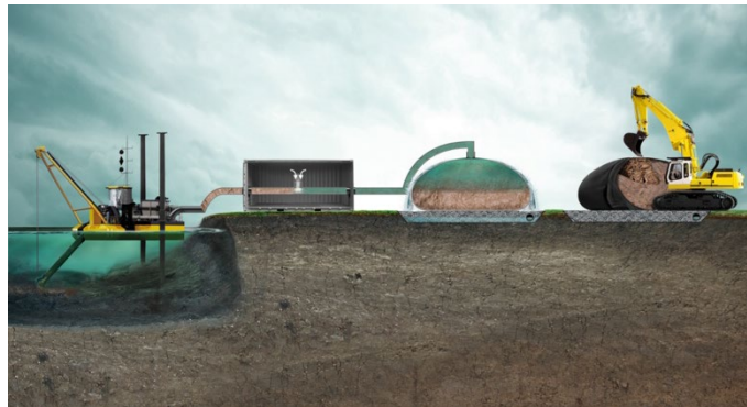
Figura 2. Schema del processo di rimozione dei sedimenti e della loro disidratazione utilizzando geotessili tubolari.
