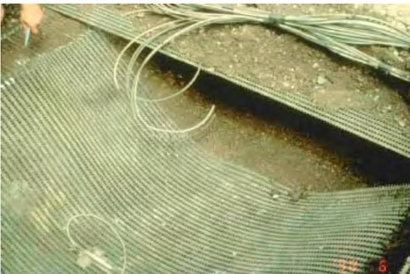
Abbildung 13: Wie Abb. 12; noch gespannte und schon durchgeschnittene Geogitter und Messgeber über dem „Erdfall“.
