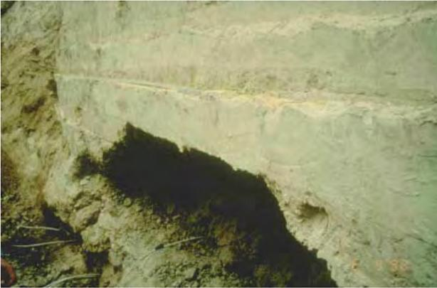
Abbildung 12: Versuchseisenbahndamm nach dem Aushub zur Überprüfung der grundlegenden Annahmen der Vorbemessung und des allgemeinen Verhaltens des stabilisierten Bodens und der Geogitter
