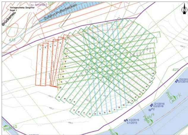
Abbildung 5: Verlegeplan untere Bewehrungslage Kegel 1
