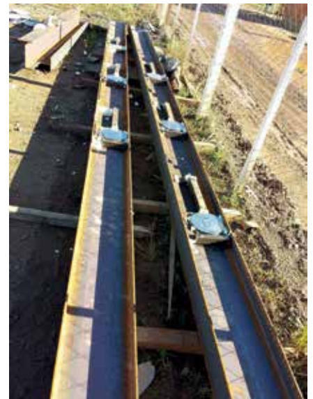
Figura 5 – Arranjo das colunas e instrumentação; Detalhe: células de carga para monitoramento do empuxo horizontal
